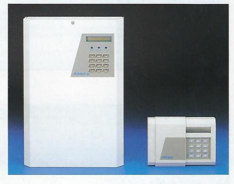
Die Advisor CD 61 weist 8 programmierbare Meldegruppen auf und kann durch Anschaltung von zusätzlichen Bedienteilen auf maximal 16 Meldegruppen erweitert werden. An die CD 61 können maximal 4 zusätzliche Bedienteile angeschlossen werden. Die abgesetzten Bedienteile können innerhalb des Sicherungsbereiches an beliebiger Stelle angeordnet und durch ein 4-adriges Kabel angeschlossen werden.
