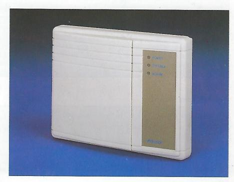
Die Zentrale CD 3404 ist mit sechs programmierbaren Meldegruppeneingängen ausgestattet und kann mit der einsteckbaren MG-Erweiterung CD 3004, oder einem Bedienteil CD 9038 mit 4 integrierten MG, auf maximal zehn Meldegruppen erweitert werden. An die Alarmzentrale können bis zu vier Bedienteile in 4-Ader-Bustechnik angeschlossen werden.
